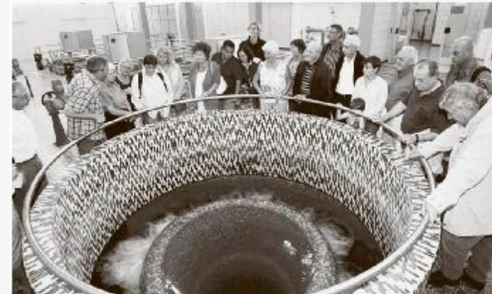
Mit einer der Wasserwerke im Rhein-Neckar-Region. Die Daphnien sind hier für die Wasserreinigung eingesetzt.
